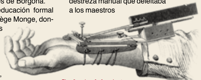
El esfigmógrafo fue el primer aparato que Marey construyó para medir el pulso.
