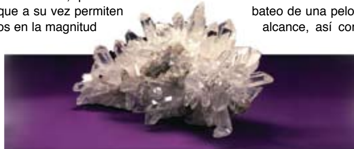
El cuarzo es un cristal piezoeléctrico.
